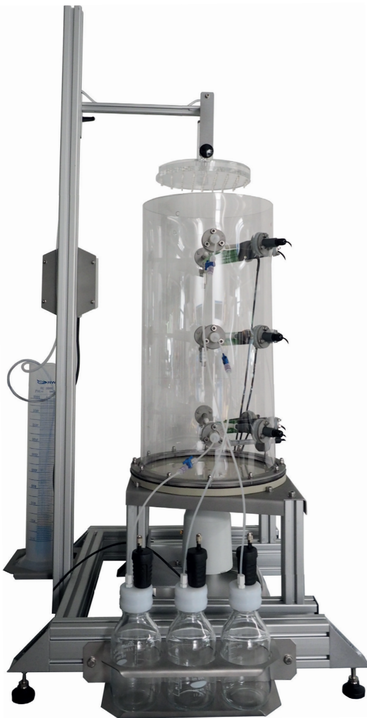
Lisímetro de laboratorio con recipiente lisímetro PET
